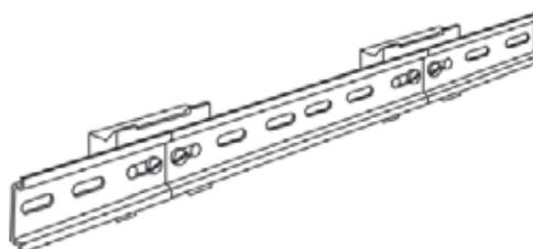
**Nota:** Cuando se utiliza el STEGOFIX como un soporte de carril DIN, sólo puede usarse el carril DIN (EN 60715) con perforaciones de 18 x 6,2 mm, o bien de 18 x 5,2 mm.
