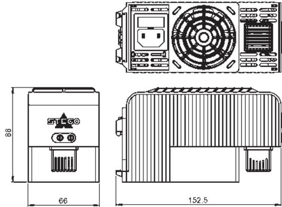
Resistencia Calefactora con termostato CSF 032
