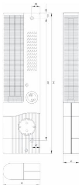
El detector de movimiento conecta la iluminación al abrir la puerta del armario eléctrico. Cada vez que se produce un movimiento se reinicia el tiempo que está conectada la lámpara. Esta lámpara puede sin ningún problema ser instalada en envoltentes con puerta de vidrio.
