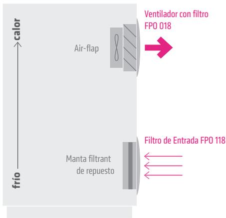
**DIRECCIÓN DEL FLUJO DE AIRE "OUT": VENTILADOR CON FILTRO FPO 018**
